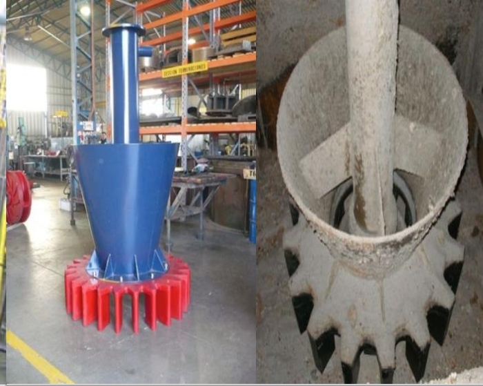
Cambio de Agitadores y Estatores en Celdas de Flotación y Celdas Unitarias
